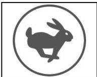
Simbolo regolatore livello velocità di avanzamento e retromarcia (versioni Innova 65B - Innova 75B - Innova 85B - Innova 100B - Innova 70S - Innova 70BTO).
